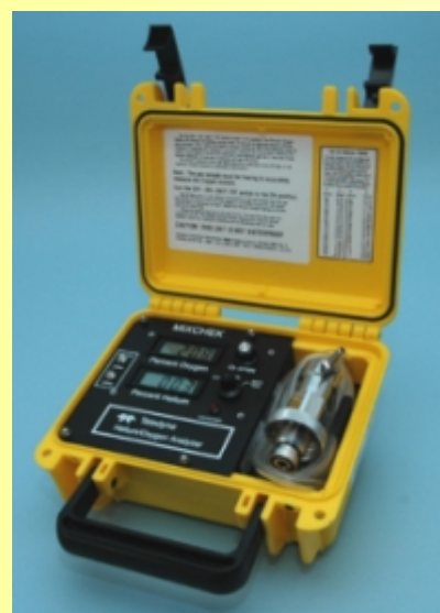
Obr. č. 36 Analyzátor obsahu kyslíku a hélia ve směsi plynů, výroba Teledyne Technologies Inc.
