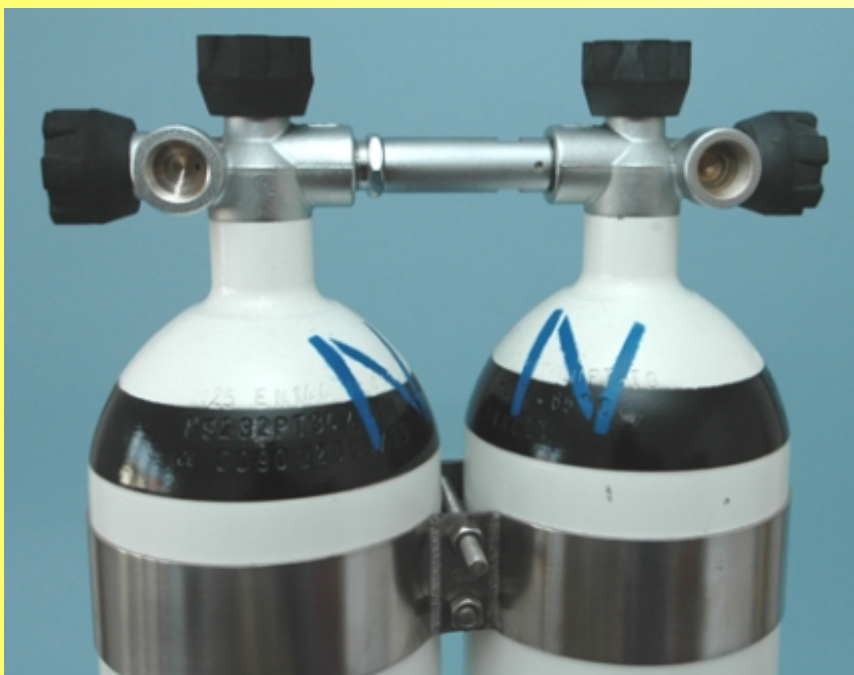
Obr. č. 18 spojení dvou tlakových lahví vzduch (dvojče), nové značení, propojení výroba LOLA
