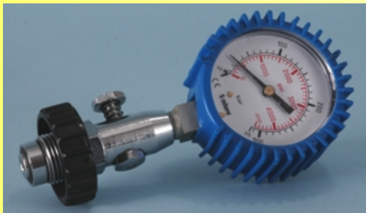
Obr. č. 22 kontrolní manometr
