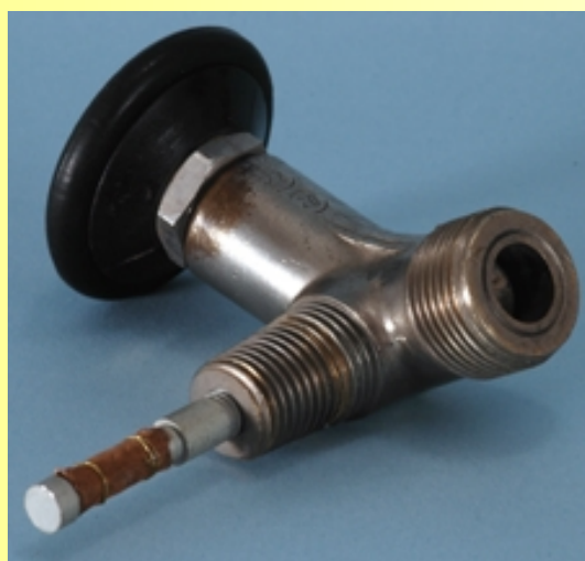
c) Ventil O 2 rohový 120°, připojení R 3/4, závit do lahve malý kužel
