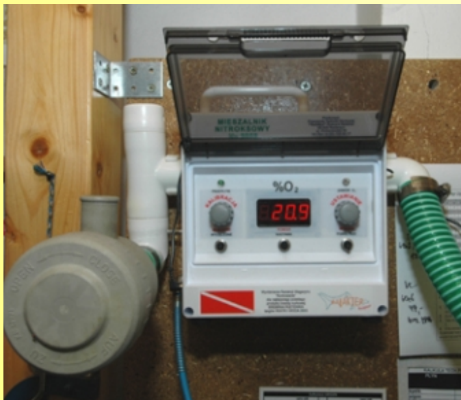
Obr. č. 33 Zařízení pro kontinuální míchání nitroxu, výroba fa. Pracownia Techniki Nurkowej "TechNur" Riszard Bałakier
